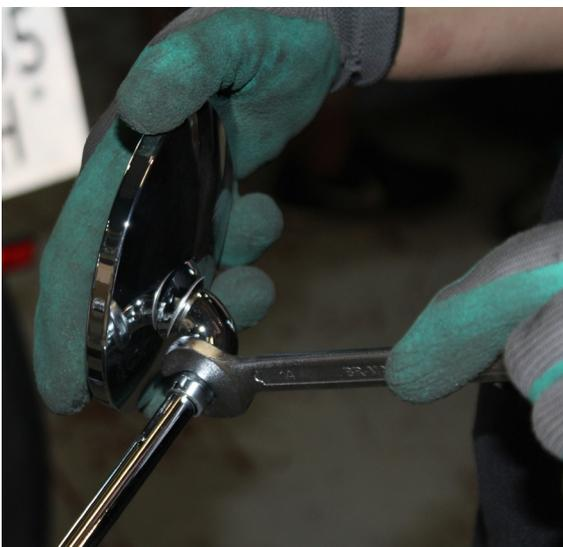
16. Colocar los espejos en la posición correcta y los apretamos suavemente utilizando una llave fija de 14mm.
