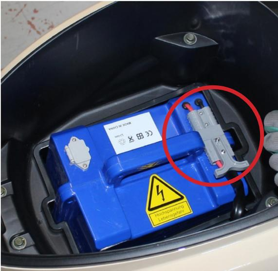
17. Conectar la batería a su conector correspondiente para comprobar si el estado de la carga y que el funcionamiento es correcto.
