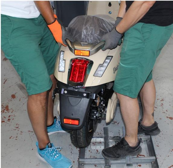
11. Una vez retiradas las cintas de sujeción, levantamos la moto por la parrilla trasera y la movemos hacia un lado para **dejar la mitad de la moto fuera de la estructura.**
