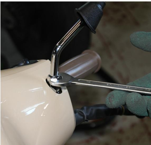
15. Enroscar y apretar usando una llave fija de 14mm.
