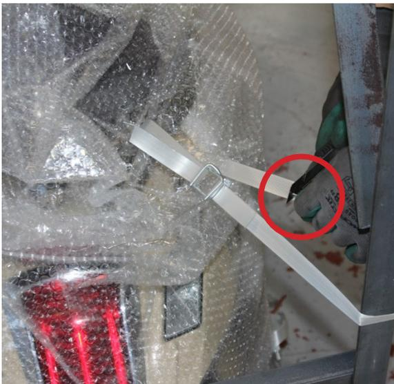
4. Utilizando un cúter, cortamos las 2 cintas que sujetan el vehículo a la mitad superior de la estructura.
