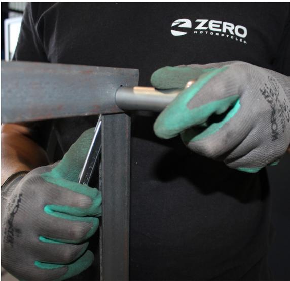
6. Para terminar de desmontar la parte superior de la estructura extraemos los tornillos superiores.
