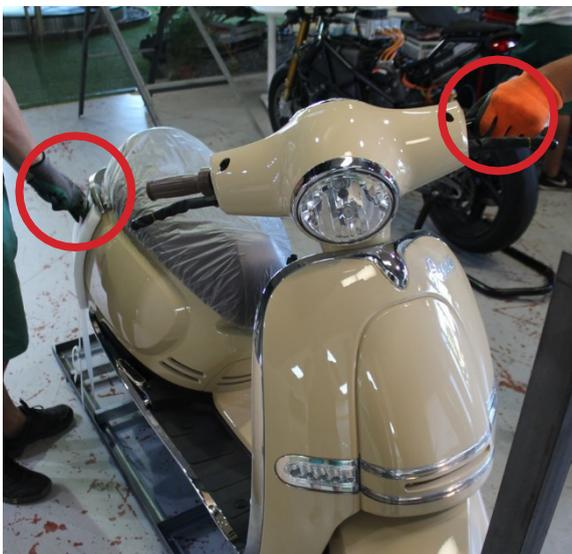
10. Utilizando un cúter, cortar las cintas que sujetan la moto a la base de la estructura metálica. Repetir la operación en el otro lado del vehículo.
