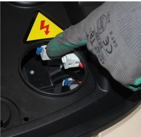
18. Encendemos el interruptor general para dar paso a la corriente. Comprobamos al arrancar la moto el estado de la batería y que las principales luces funcionan
