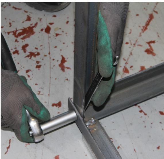
5. Desatornillar la parte superior de la estructura empezando por extraer los tornillos inferiores.
